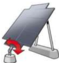
8 – сурет -Айналу осьі полярлы бір осьті күн трекері
