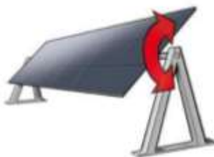
9- сурет - Айналу осьі горизантальды бір осьті күн трекері
